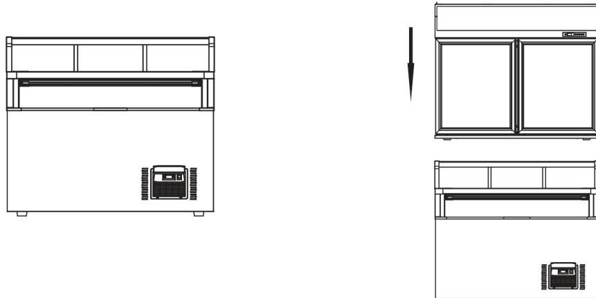
3. Nadat u de locatie van het gat in de onderkast en de bovenkast hebt uitgelijnd, zoals op de afbeelding te zien is, schroeft u de verstelbare voet (M8x50) vast op de aangegeven gatpositie en bevestigt u de bovenkast stevig op het platform. De operatie vraagt om hulp.
