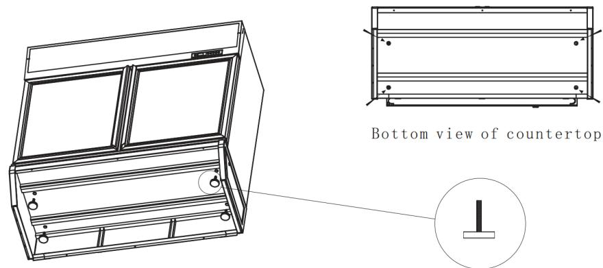
4. De juiste stapelstatus is: zoals weergegeven moeten de achterkant van de bovenkast en de onderkast op één lijn liggen, en moeten de twee zijkanten op één lijn liggen.
