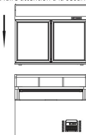
3. Après avoir aligné l'emplacement du trou sur l'armoire inférieure et l'armoire supérieure comme le montrent les images, vissez le pied réglable (M8x50) à la position du trou indiquée, fixez fermement l'armoire supérieure sur la plate-forme. L'opération demande une armoire supérieure auxiliaire.
