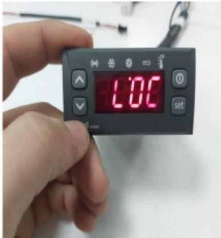
After entering the parameter screen, press the up or down arrow keys. Move to the «LOC» parameter and press the «set» key.
